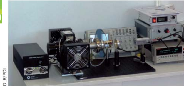
Das THz-Lasersystem von DLR und PDI wiegt nur 15 kg und eignet sich hervorragend für den mobilen Einsatz.
